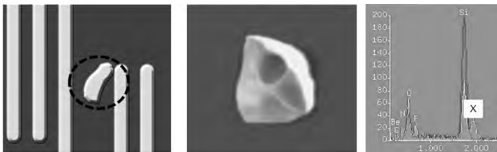
图 5.4 栅极残留缺陷、掉落的含 X 元素的小颗粒和元素分析图
