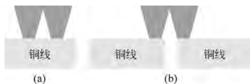
图 5.1 通孔短路的不同情况
