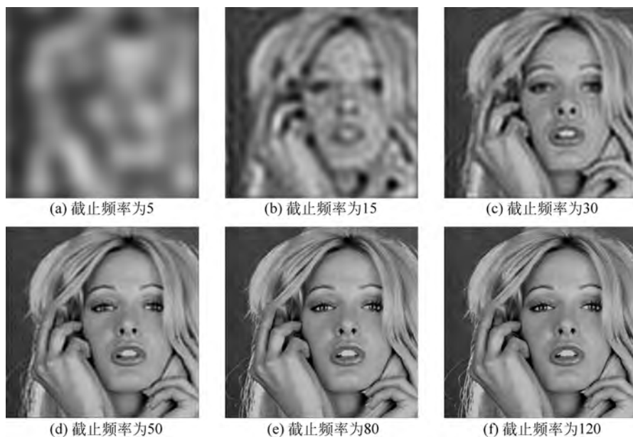
图 5-6 截止频率为 5、15、30、50、80 和 120 的理想低通滤波器的滤波结果
