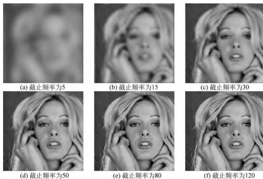
图 5-14 截止频率为 5、15、30、50、80 和 120 的二阶指数低通滤波器的滤波结果
