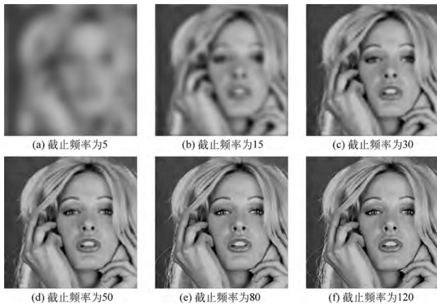
图 5-10 截止半径为 5、15、30、50、80 和 120 的二阶巴特沃斯低通滤波器的滤波结果
