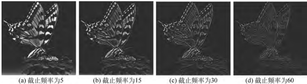
图 5-26 截止频率为 5、15、30 和 60 的二阶指数高通滤波器的滤波结果
