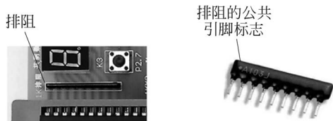
图 1-3 排阻电阻器实物照片及安装示意图
