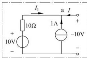
图 3-7 例 3-3 电路参考方向标注
