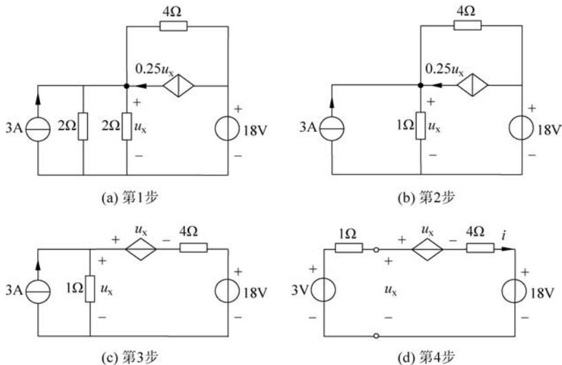
图 3-22 例 3-6 变换求解过程
