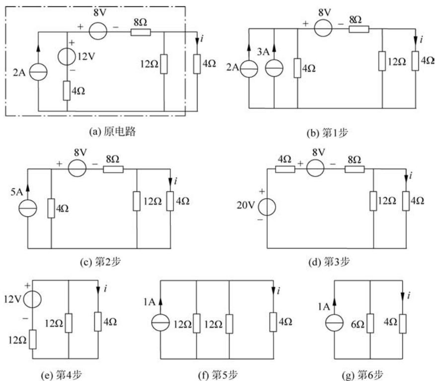
图 3-20 例 3-5 变换求解过程
