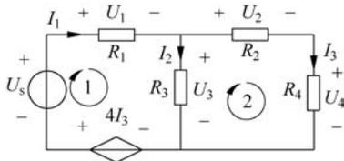
图 3-5 例 3-2 电路电压极性标注
