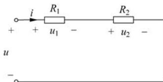
图 3-9 两个线性电阻串联
