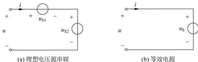
图 3-14 电压源串联
