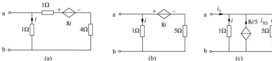
图 3-25 例 3-7 电路求解过程
