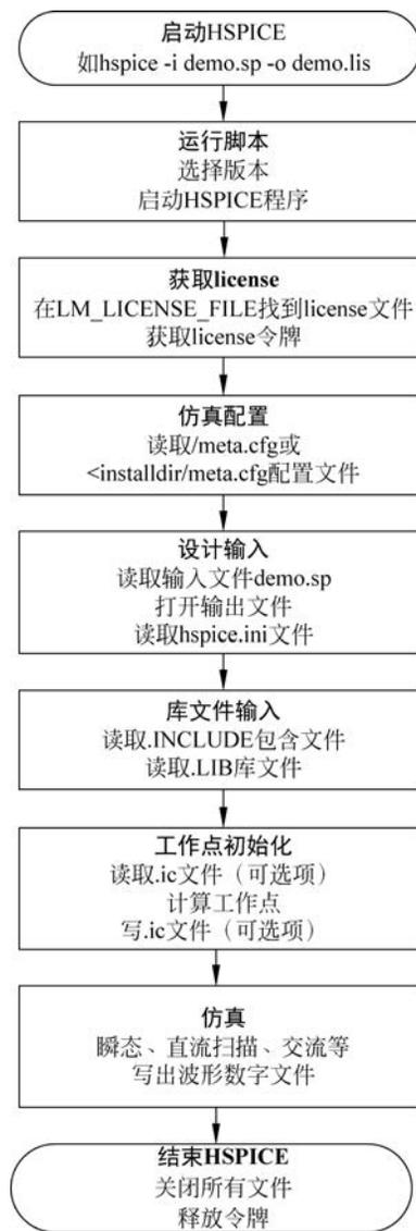
图 3-1 HSPICE 工具的基本仿真流程
