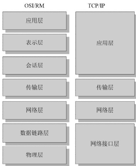
图 1-7 TCP/IP 协议与 OSI 模型间的对比
