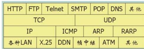
图 1-8 TCP/IP 协议集的构成
