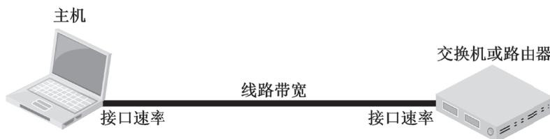
数据传送速率 =  $\min(\text{主机的接口速率}, \text{线路带宽}, \text{交换机或路由器的接口速率})$
