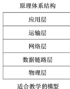
图1-37 五层协议的原理体系结构
