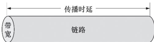
图1-26 将链路看作一个圆柱形管道
