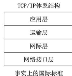
图1-33 TCP/IP四层协议体系结构
