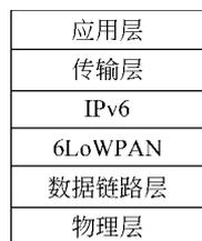
图 5.2 边缘路由器模式下的体系结构
