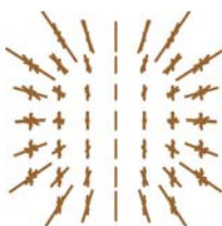
通过手机镜头的离轴光束的二向衰减,逐面重叠在出瞳中
