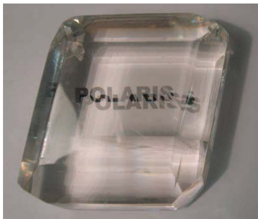
图 1.14 通过方解石传播的光分解为两种模式,它们沿着不同的路径传播,产生两个图像
