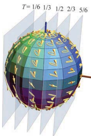
图 6.15 对于二向衰减器,垂直于透光轴的线表示一组透过率相等的偏振态。
