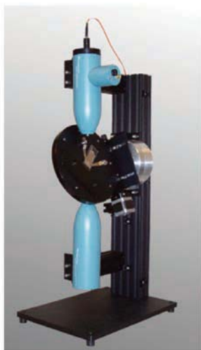
图 1.13 (a)米勒矩阵成像偏振测量仪,通过多种照明偏振器件和分析偏振器件组合对样品进行照明和测量,可测量样品的米勒矩阵、二向衰减、延迟和退偏。这个米勒矩阵偏振计通过一个线偏振器和一个可旋转角度的延迟器对样品进行照明。光和样品相互作用,出射光偏振态发生改变。根据测量需求,光可以经由样品反射、透射、衍射或散射。出射光偏振态的变化可以在光进入相机或辐射计之前,通过一个旋转角度的延迟器和一个线偏振器来分析。(b)用于透射米勒矩阵测量的商用米勒矩阵偏振计。这个偏振计每秒可以测量 30 个米勒矩阵。光源和偏振发生器位于仪器上部,分析器和探测器位于仪器底部。(由 Alabama 州 Huntsville 地区的 Axometrics 公司提供)
