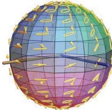
图 6.17 特殊非齐次偏振器的偏振特性的庞加莱球表示法, 该非齐次偏振器由水平偏振器后接 45^\circ 偏振器组成。棕色线段表示二向衰减轴, 蓝色线段表示偏振度轴
