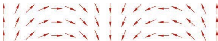
图 4.12 频率差为 5% 的等振幅的左右旋圆偏振光叠加产生旋转线偏振态
