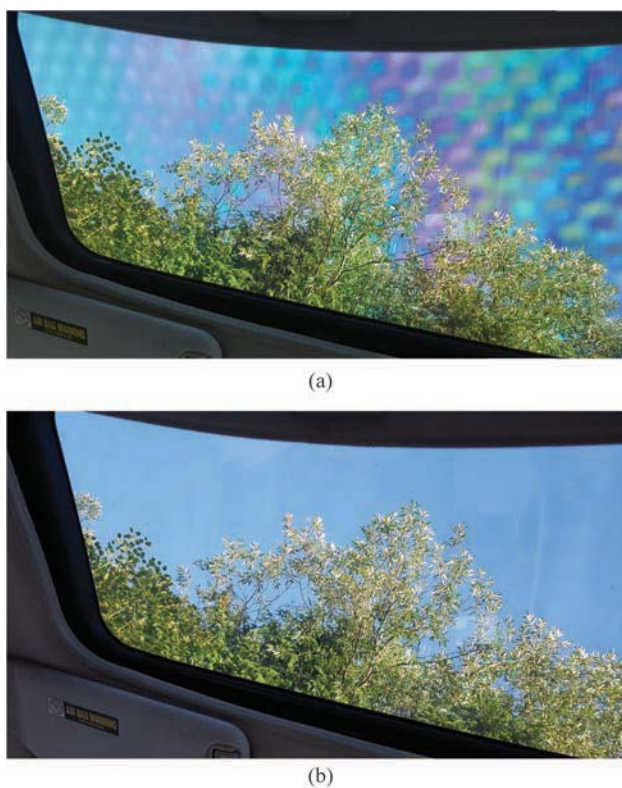
图 1.2 在晴天用带有(a)和没有(b)偏振滤光镜的相机拍摄车窗顶。 彩虹棋盘图案揭示了钢化玻璃的应力双折射现象
