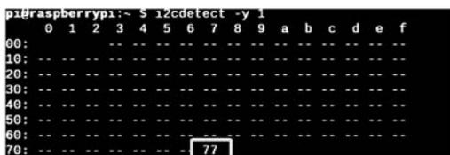
图 3-17 i2cdetect 查看已连接的 I<sup>2</sup>C 设备
