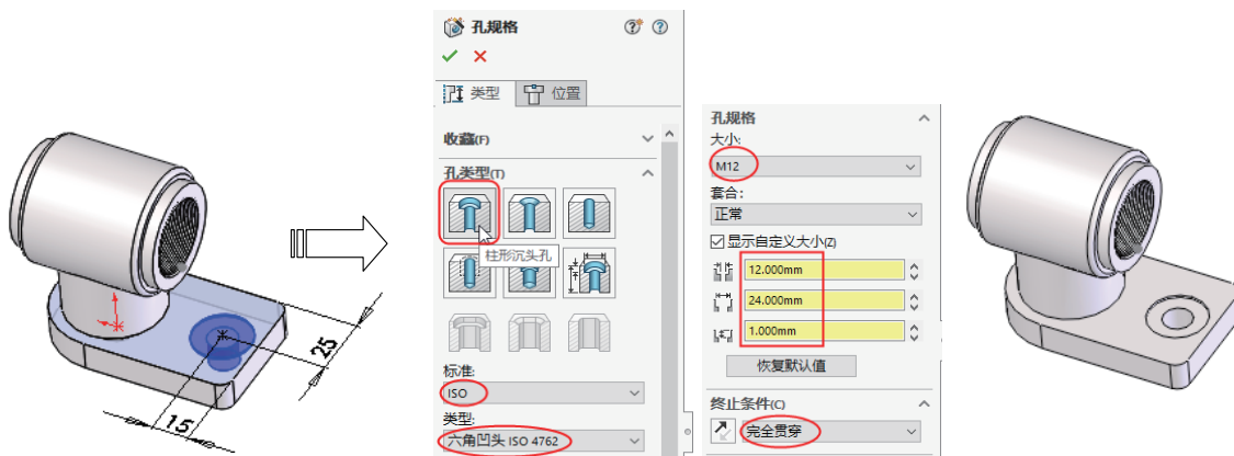
图1-91 创建阀体底座的沉头孔
