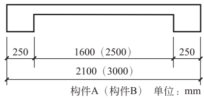
图 1-21 尺寸的简化标注
