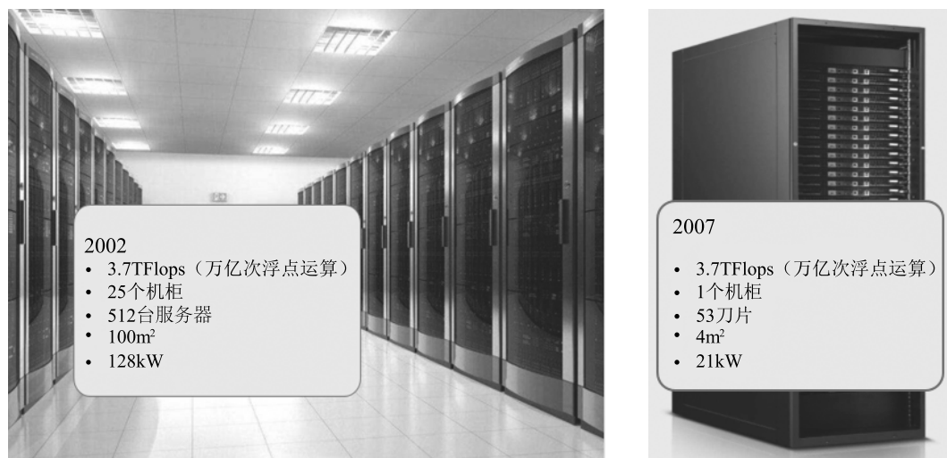
图 2.12 在同等计算能力下消耗的机柜、服务器数量、占地和耗电对比
