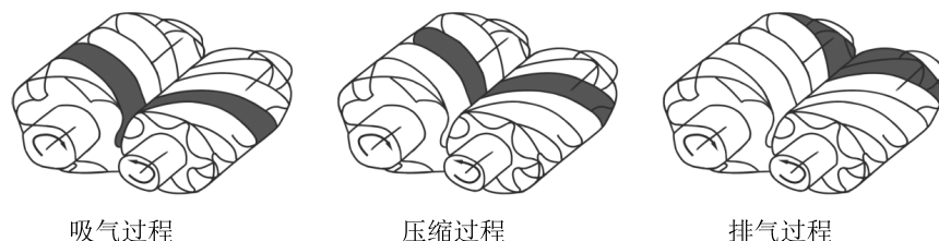
图 2.34 螺杆式压缩机的工作过程示意图
