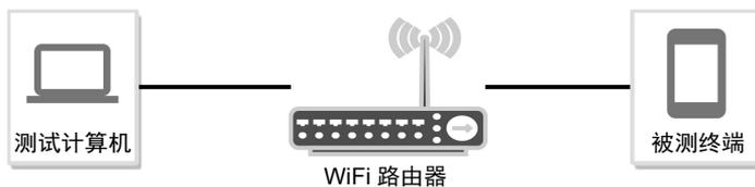
图 1-5 Remote SIM Provisioning 测试连接图
