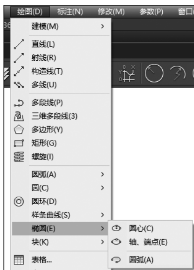
图 3-31 画椭圆及圆弧的方法
