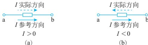
图 1.7 电流参考方向与实际方向的关系
