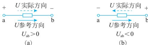
图 1.8 电压参考方向与实际方向的关系
