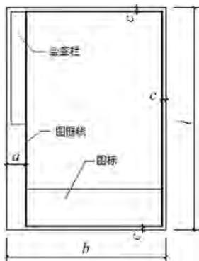
图 1-9 A4 图幅格式
