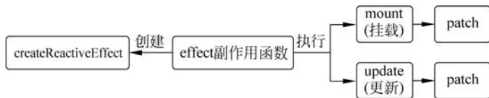
图 5.5 createReactiveEffect() 函数流程
