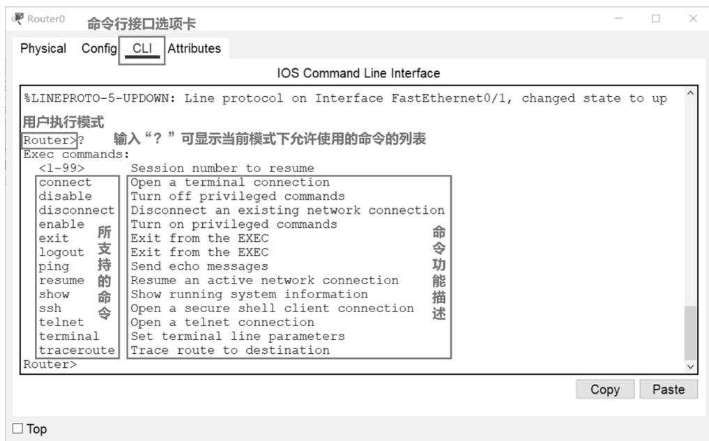
图 1-42 路由器的用户执行模式下允许使用的命令列表
