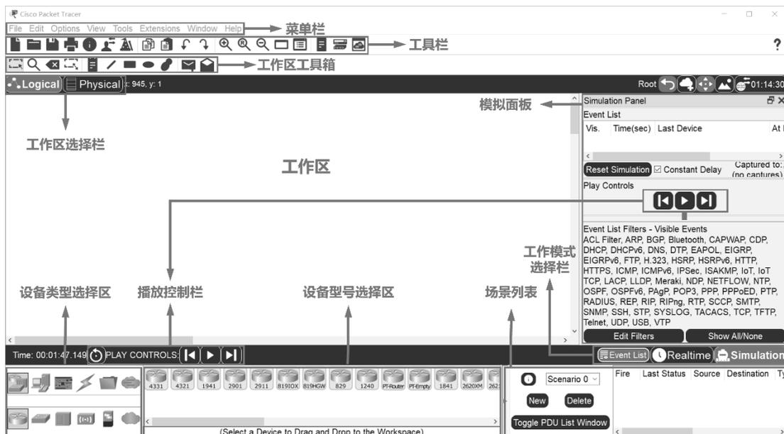
图 1-3 Packet Tracer 软件的用户界面
