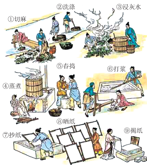
图 1-3 清朝造纸工艺流程图
