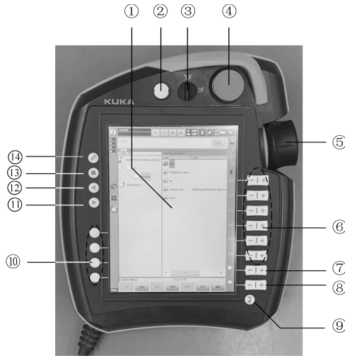
图 1.4 smartPAD 正面结构
