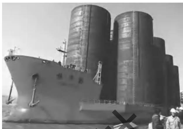
图 1.3.1 港珠澳大桥人工岛围护钢圆筒
