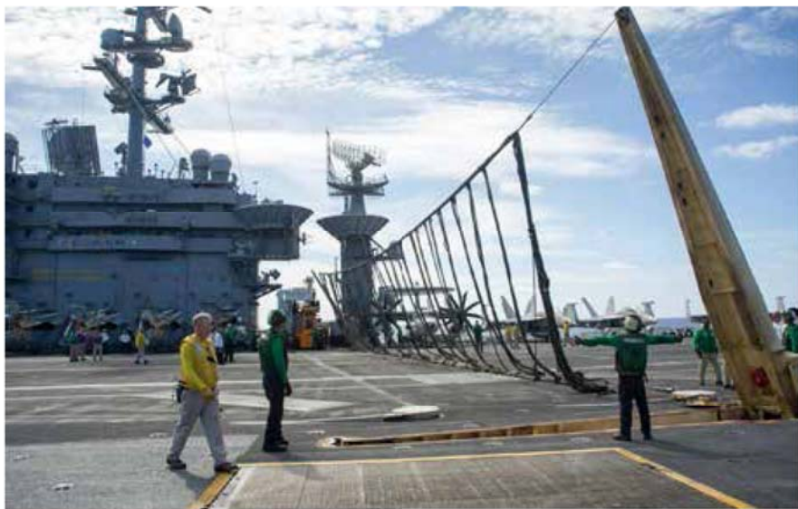
利用两侧支柱竖立起来的拦阻网
