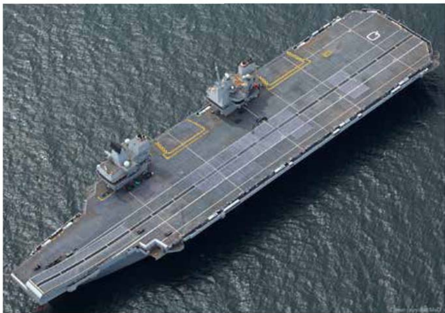
英国海军“伊丽莎白女王”级航空母舰设在舰岛后方的2部升降机（黄色标识）
