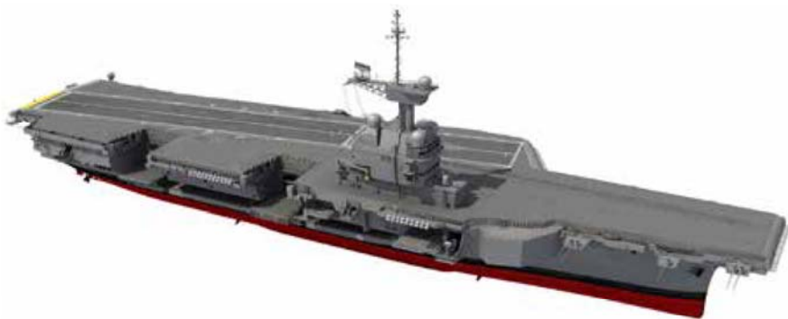
采用斜角甲板的法国海军“戴高乐”号航空母舰
