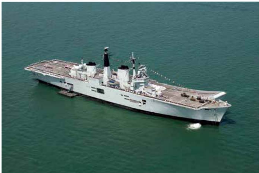
装有滑跃甲板的英国海军“无敌”级航空母舰
