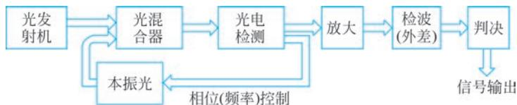
图 5-60 相干光通信结构
