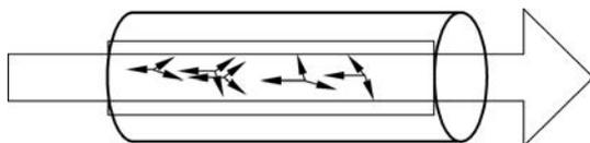
图 5-20 光纤中的散射示意图
