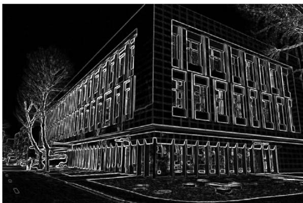
图 5.7 使用 Sobel 算子计算出的梯度幅值图像
