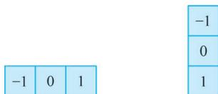
图 5.27 HOG 使用的梯度检测算子
