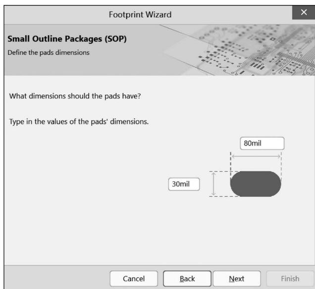
图 3-29 设置焊盘尺寸
