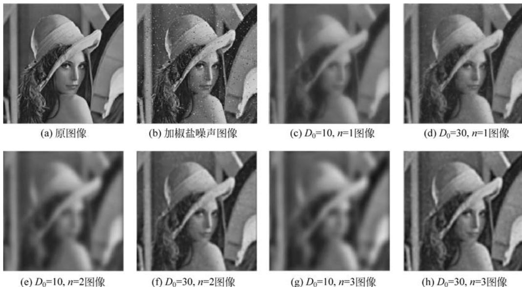
图 5.14 例 5.6 利用巴特沃斯低通滤波器进行图像去噪实验结果
