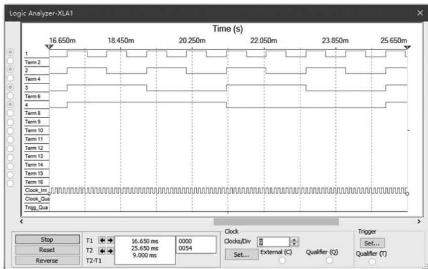
图 5.98 异步 3 位二进制减法计数器仿真时序波形
