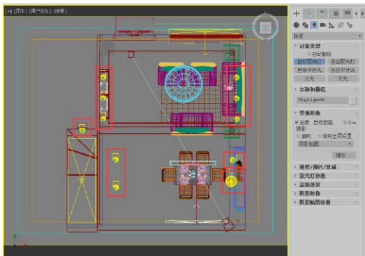
图 7.26 设置吊灯和射灯照明
