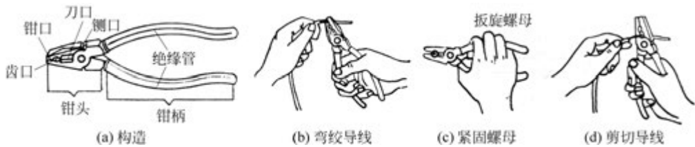
图 1-6 钢丝钳的构造及应用
