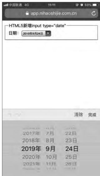
图 2-8 在 iOS 中使用 input type="date" 的显示结果
