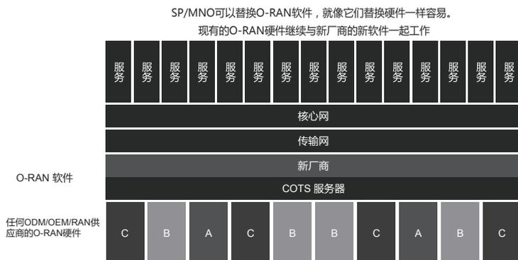
图 1-9 O-RAN 软硬件解耦架构
