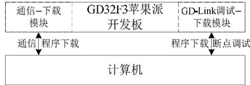
图 1-2 GD32F3 开发板与计算机连接图
