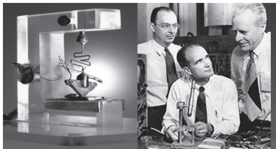
图 1-11 全球第一个晶体管和发明它的肖克利、巴丁、布拉顿
