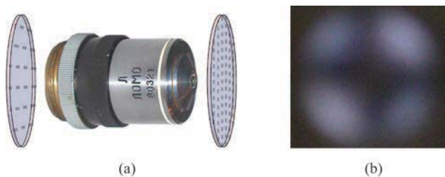
图 15.52 (a)正交偏振器之间的显微物镜,(b)出瞳中的光通量分布
