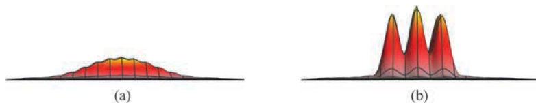
图 16.29 以相同比例绘制的 (a) 像的水平偏振分量和 (b) 像的垂直偏振分量
