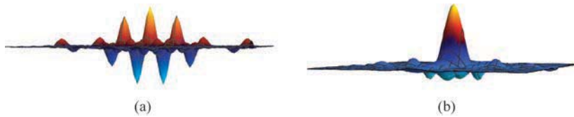
图 16.23 (a)该 ARM 的(1,1)分量是由水平偏振器双缝 JP(x, y) 形成的干涉图案。幅值在-4.40 和 4.71 之间变化。(b)ARM 的(2,2)分量的夫琅禾费衍射图案是由垂直偏振器作为矩形单缝 JP(x, y) 产生。幅值在-2.04 和 9.42 之间变化
