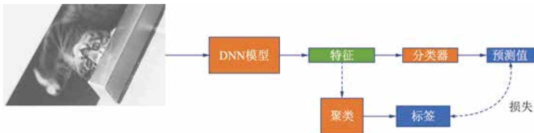
图 4.22 基于伪标签的训练原理
