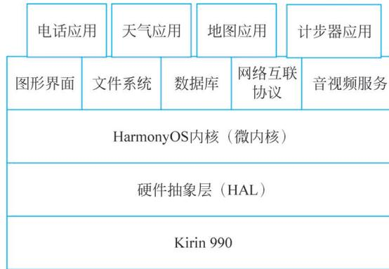
图 3-8 基于 HarmonyOS 的手机多任务功能结构框架
