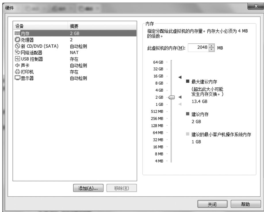
图 1-11 设置虚拟机的内存量
