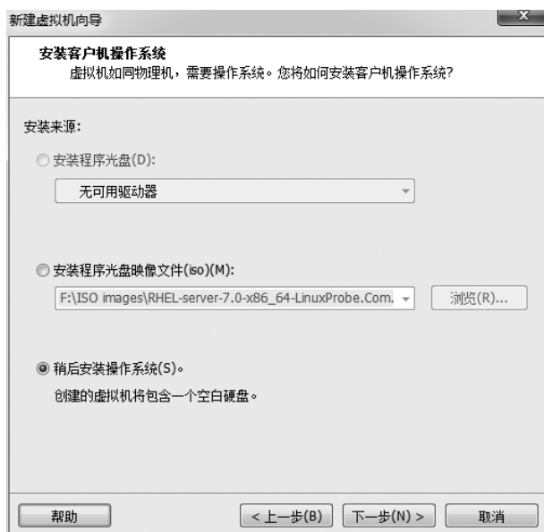
图 1-6 选择虚拟机的安装来源
