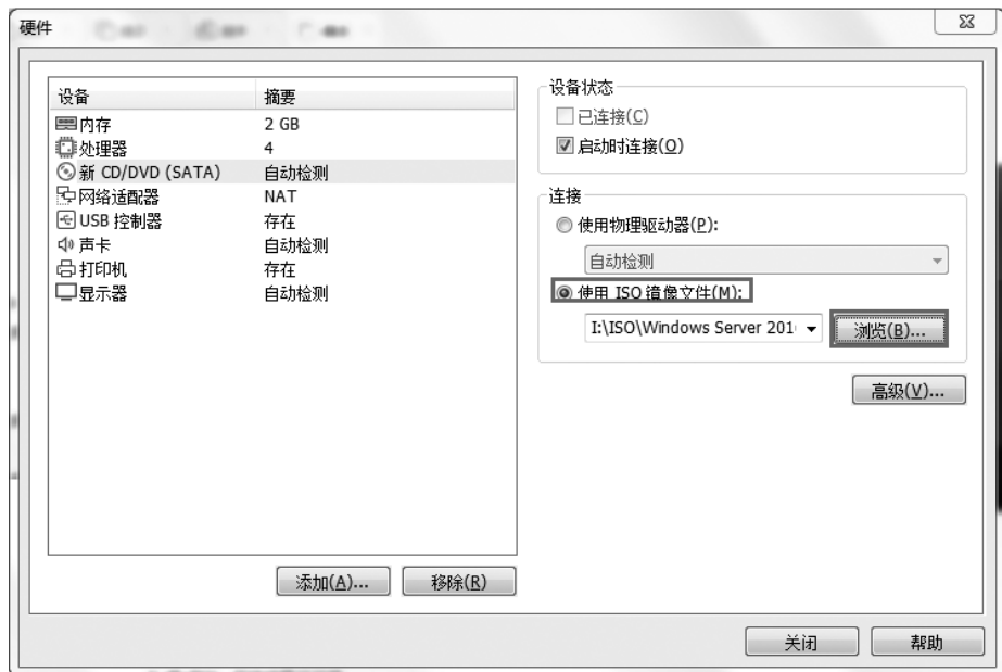
图 1-13 设置虚拟机的光驱设备
