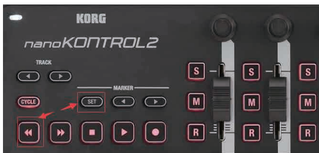
图 1-235 第一次使用时先同时按住 SET 键和后退键然后再插入电源线
