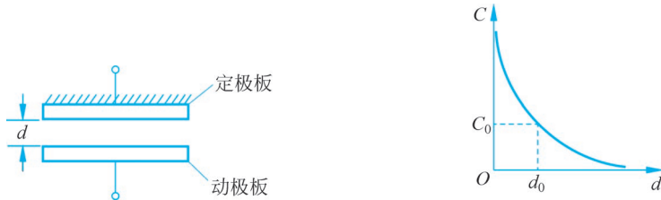
图 5-6 变极距型电容传感器示意图
