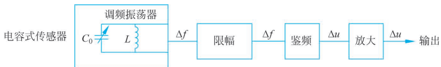
图 5-9 电容传感器调频电路
