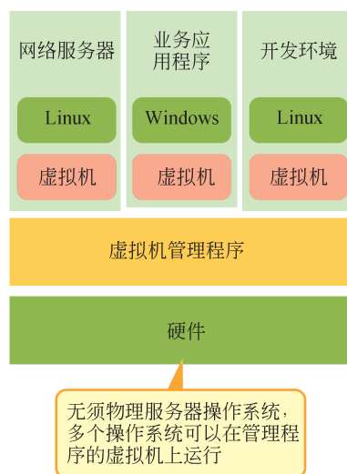
图 5.3 主机操作系统和虚拟机管理程序的两种类型的虚拟化
