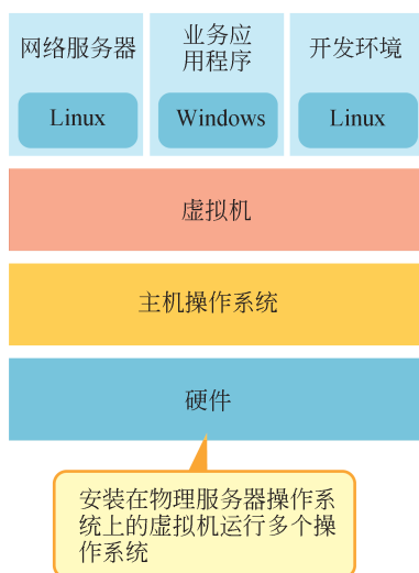
图 5.3 主机操作系统和虚拟机管理程序的两种类型的虚拟化
