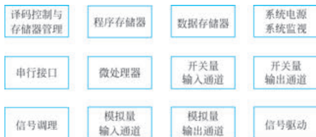
图 5.1.1 单片机系统的基本组成
