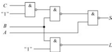
图 3-13 例 3-5 用与非门构造的逻辑电路图
