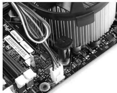
图 1-7 连接风扇电源
