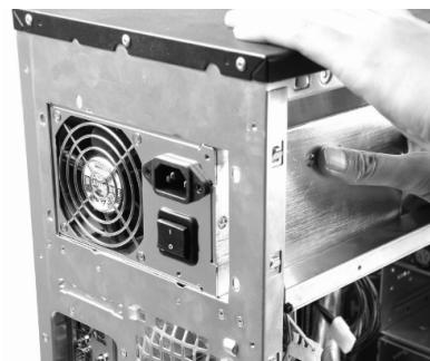
图 1-18 安装电源
