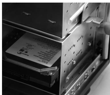
图 1-16 固定硬盘托架
