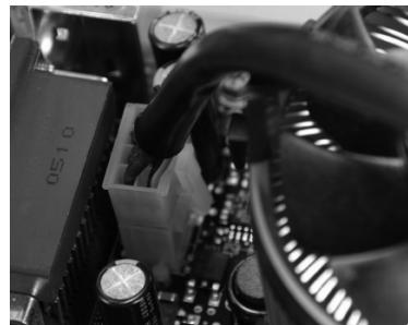
图 1-23 连接 CPU 供电电源
