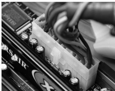
图 1-22 连接主板电源
