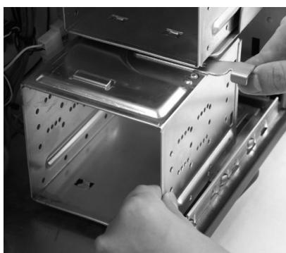
图 1-13 取出硬盘托架
