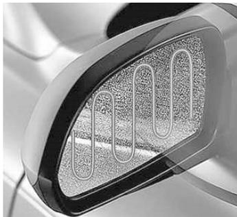
图 5-4 汽车后视镜上的电热丝
