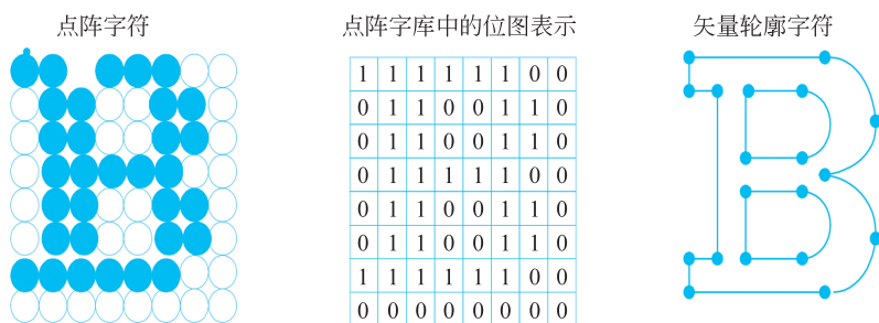
图 3-12 点阵字符、点阵字库中的位图表示、矢量轮廓字符
