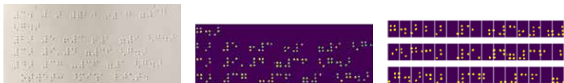
图 6-1 对盲文书籍照片进行预处理，以进行盲文符号分离提取的过程。来自 OpenCV.zh.ipynb 文件中的图像
