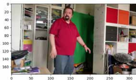
图 6-15 程序将 BGR 色彩空间的图像转换为 RGB 色彩空间后，图像的颜色正常了
