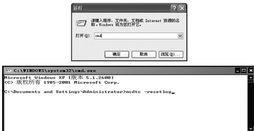
图1-6 运行CMD及输入msdtc -resetlog命令
