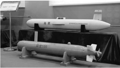
图 1-16 “探索 100”便携式 AUV 和“海翼”UG
