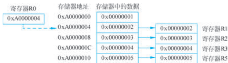
图 3-2 多寄存器寻址方式示意图
