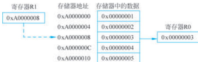
图 3-1 寄存器间接寻址方式示意图
